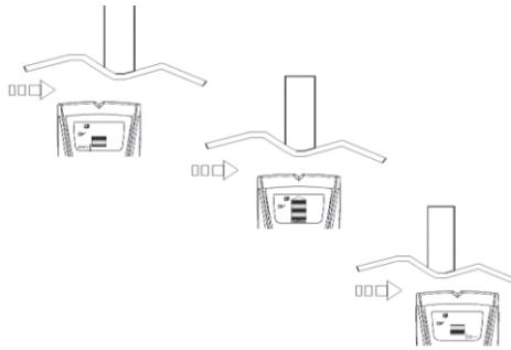
**! W przypadku otrzymywania niespójnych wyników skanowania może to być spowodowane wilgotią na powierzchni lub w zagęszczeniach w ścianie lub płytcie gipsowej. Przyczyną może być również niewyschnięta do końca farba lub tapeta.**
