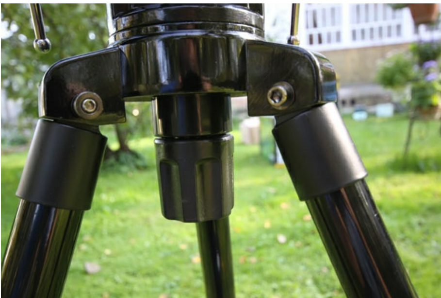
На фотографиях показаны узел крепления монтировки и треноги, а также винт крепления полочки с принадлежностями:
