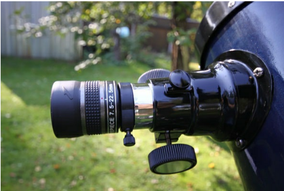
Крепление искателя осуществляется при помощи двух винтов.
