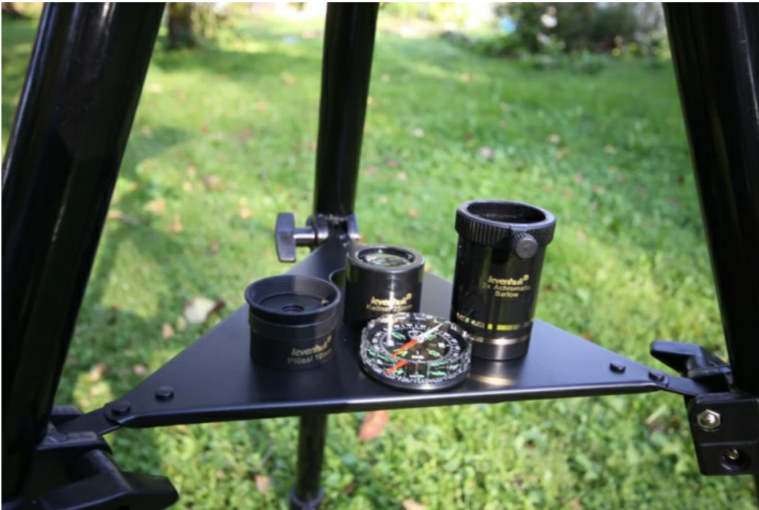
Тренога у телескопа двухсекционная, выдвигаемая и регулируется под рост наблюдателя.
