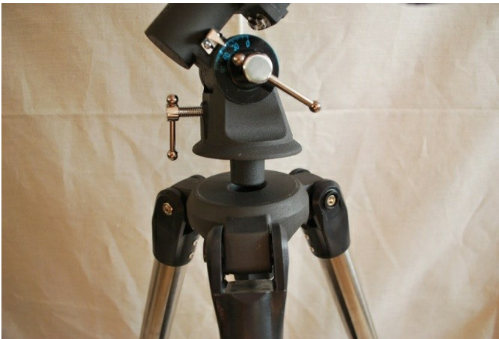
Установка головы монтировки на треногу
