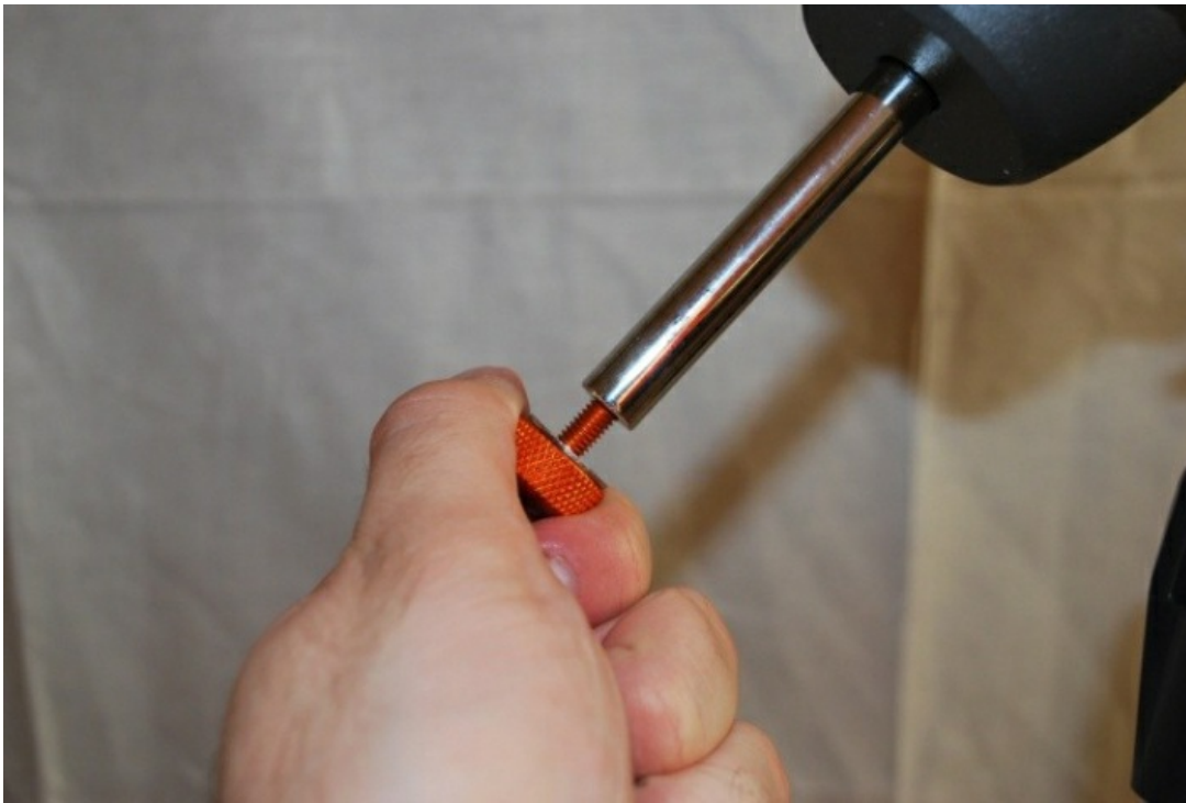
Закручивание стопорного винта на стержне для противовесов
